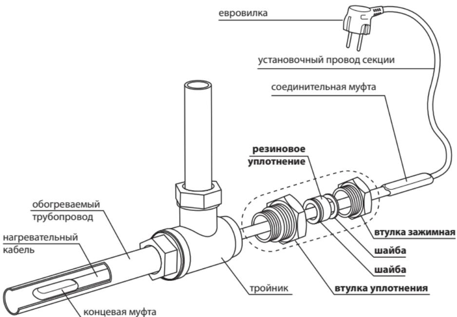
Рисунок 1. Пример монтажа (сборки) сальникового узла на нагревательный кабель.
